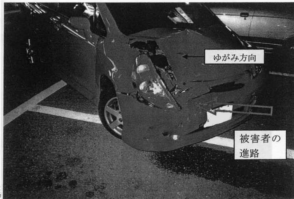
写真 4 被疑者車両に右前部の凹損状況
