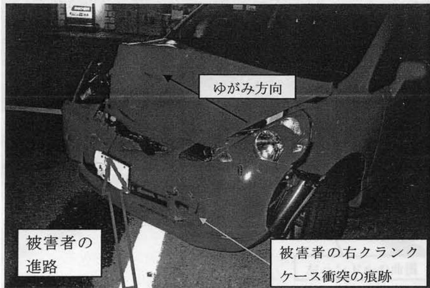
写真 3 被疑者車両の左前面の凹損状況
